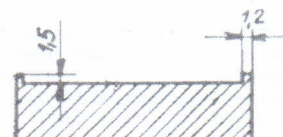
Obr. 2 Příprava ploch frézováním u oceli
